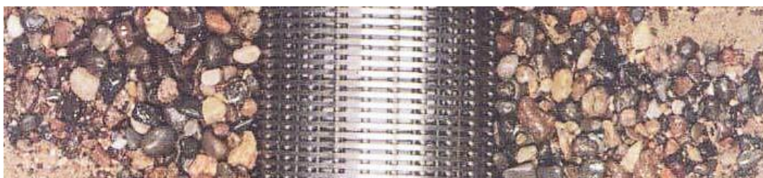
Figura 7: Filtro de grava en pozo para agua
